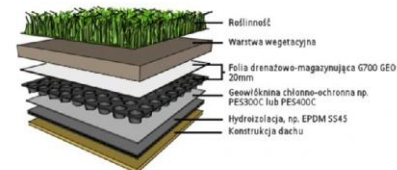
Warstwy przy kładzeniu zielonego dachu.
