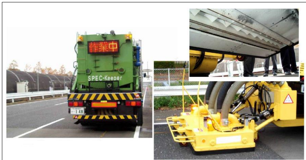
Rysunek 1. Sprzęt wykorzystywany przy oczyszczaniu nawierzchni z asfaltu porowatego [Źródło: Zastosowanie nowoczesnych technologii w konstrukcjach drogowych, Zakopane 15-17.09.2010 r.]
