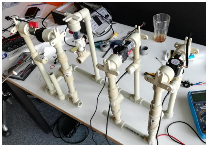
Rysunek 22 PoC systemu służącego do bieżącego monitoringu stanu jakości wody, wykrywania bakterii E. coli firmy Cybercom
